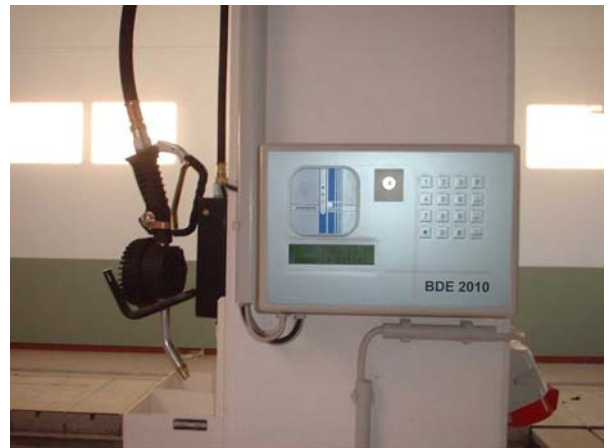
Tankautomat als Ölterminal (Wandmontage)
